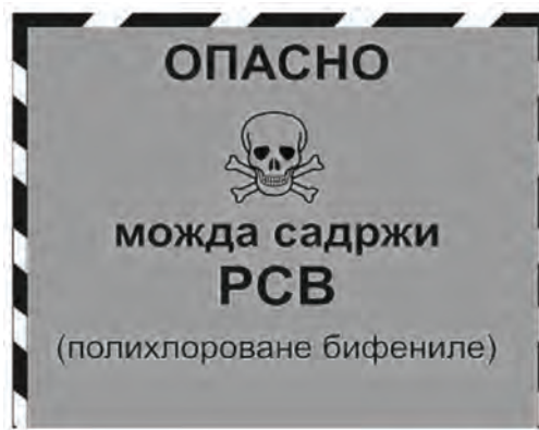
Слика 22. Ознака уређаја који можда садржи PCB
