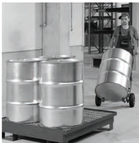
Слика 11. Палета са танкваном за одлагање бурад са отпадним уљима унутар радионица
