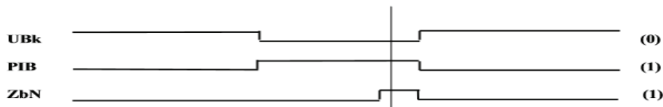
Слика 15. Принудно кочење УБ — уређаја будности
