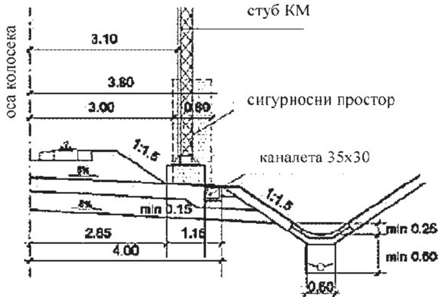
Слика 16б: Канал за каблове у ивичној стази поред стуба контактне мреже
