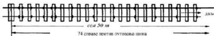
Слика 4: Положај справа против путовања шина код колосека завареног у ДТШ
