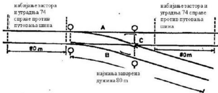
Слика 42: Уградња справа против путовања шина
