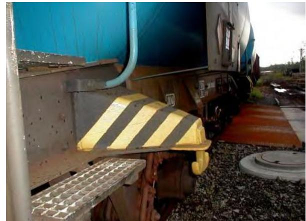
**Mesto:** Vučna kuka i njen štitnik sa ispustom većim od 150 mm, kao i svi oslonci i konzolni nosači kuka moraju se obojiti kako sledi:
