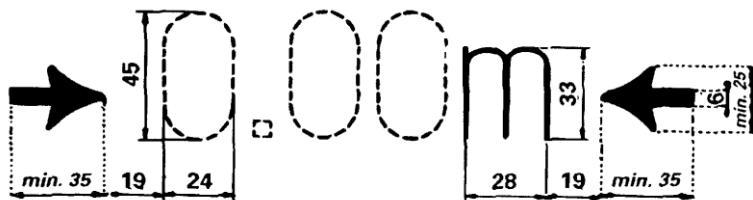
**Mesto:** Na desnoj strani svakog podužnog nosača ili na ramu obrtnog postolja (dovoljno je da se ova oznaka nalazi na levom obrtnom postolju sa svake strane kola) ili na delovima koji prekrivaju podužni nosač ili na posebnim tablama koje su postavljene u visini podužnog nosača.
