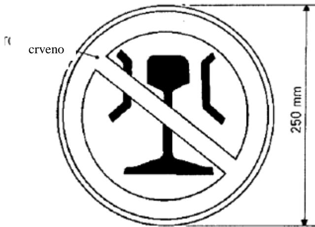
**Mesto:** Na levoj strani svakog podužnog nosača ili na delovima koji prekrivaju podužni nosač ili na posebnim tablama postavljenim u visini podužnog nosača.
