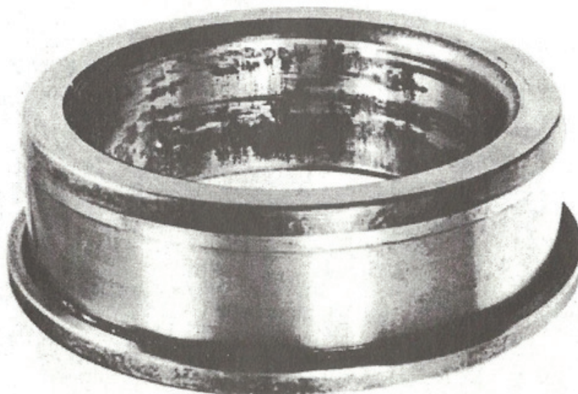
Слика 30. Контактна корозија на додирној површини унутрашњег прстена цилиндрично-ваљчаног лежаја
